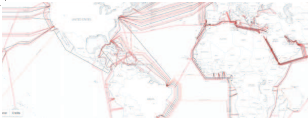
- Cables submarinos de fibra óptica. Unos 700.000 km de cable son la base de la red mundial de telecomunicaciones.
